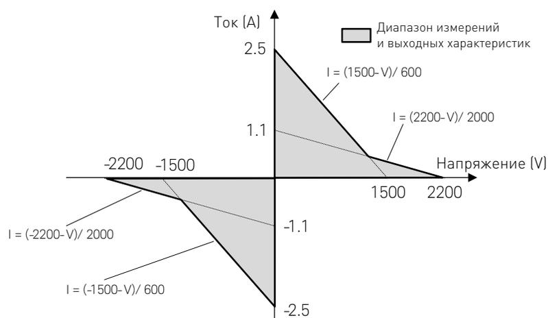
Выход модуля HVMSU доступен только в импульсном режиме.
