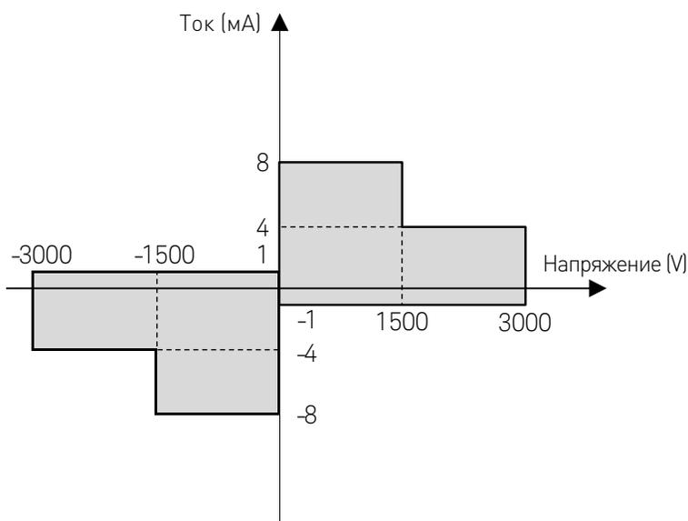
У модуля HVSMU есть 3 настройки выходных диапазонов: «от 0 до +3 кВ», «от -1500 В до +1500 В» и «от 0 до -3 кВ». Если в прибор B1505A установлено более одного модуля HVSMU, то все модули HVSMU должны использовать одну и ту же настройку выходного диапазона.
